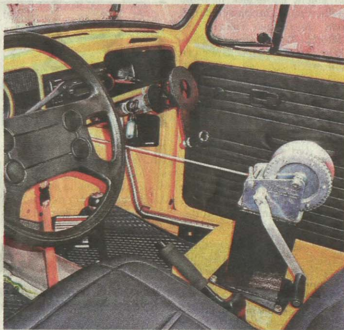
Rechts-Links-Lenker: Mit den zwei Lenkgetrieben steuert der Fachmann den VW sowie den selbst konstruierten Schneeschild.
